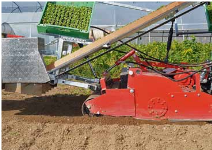
Die Pflanzmaschine ist noch ausgehoben, während die Bodenfräse schon arbeitet. So wird bis an den Rand eines Beetes gearbeitet.
