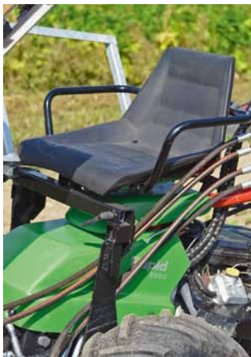
Für den Sitz des Beladers wurde der Rahmen des Einachsers verstärkt.
