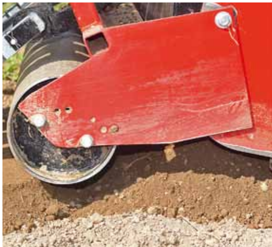
Die Bodenfräse kann ausgehoben werden, während die Pflanzmaschine noch arbeitet.
