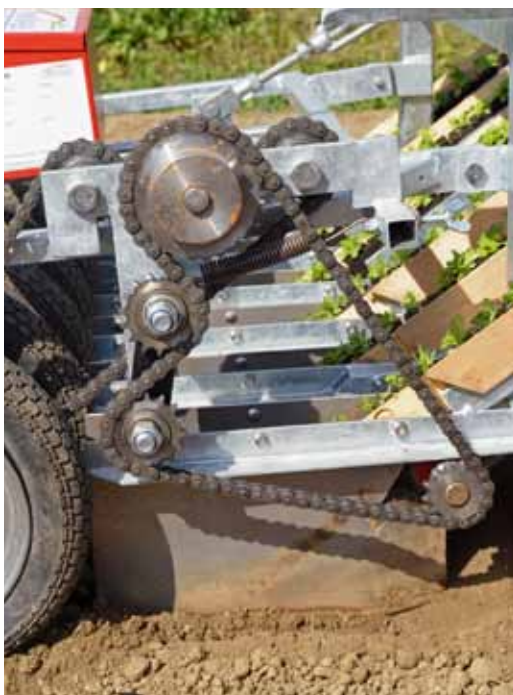
Das Herzstück der Pflanzmaschine: das Getriebe. Damit wird der Pflanzabstand eingestellt.
